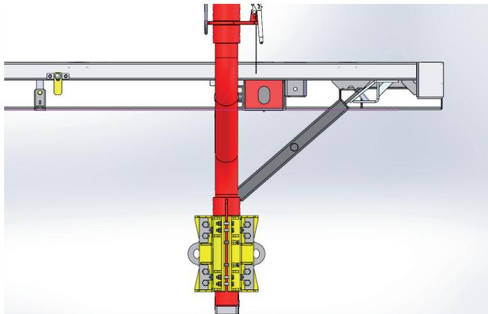
Durch die innovative Anschlagereinrichtung können alle Montagearbeiten zur Einrichtung des **Wecon HaltMaX** am Boden ausgeführt werden. So ist sichergestellt, dass der Mitarbeiter beim Aufstieg auf die Ladung bereits mit der Höhensicherung verbunden ist.
