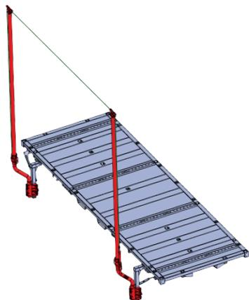
**Wecon HaltMaX** eignet sich als Absturz- und Ladungssicherung für eine Person auf der Ladung von Wechselbrücken und ist für eine Nutzungskapazität bis maximal 150 kg geeignet. Direkt am Wechselrahmen montiert, funktioniert **Wecon HaltMaX** als horizontale Anschlagvorrichtung. Hier wird die persönliche Schutzausrüstung gegen Absturz (PSAgA) mit einem Karabiner am Höhensicherungsgerät befestigt.
